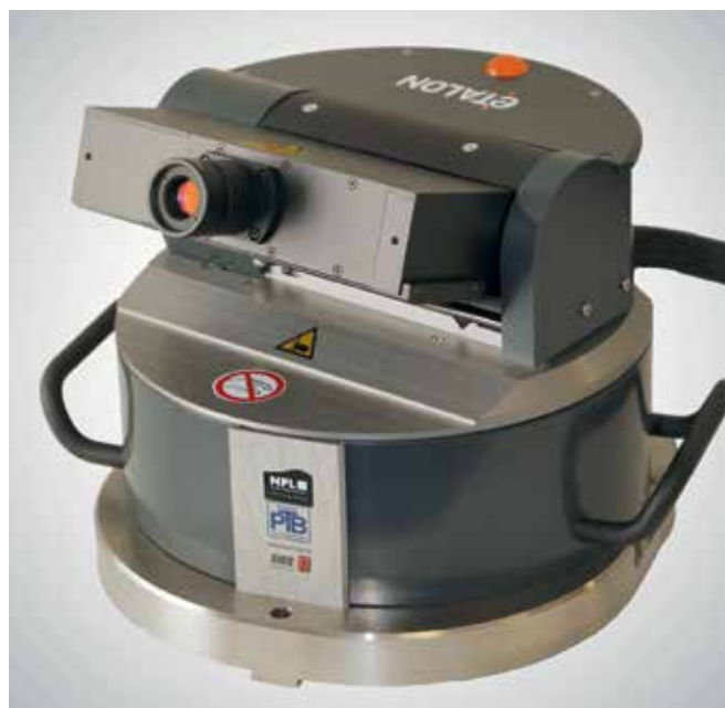
Bild 2. LaserTracer: benötigt weniger Zeit für die KMG-Überwachung
