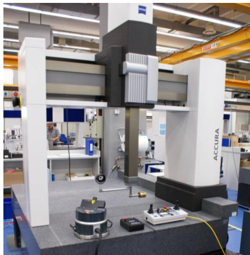
Bild 4: Einsatz eines Lasertracers zur Kalibrierung von Portalmeßgeräten in der Produktion von Zeiss IMT © Zeiss IMT
